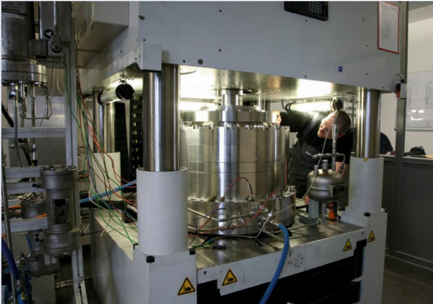
Auf eigenen Prüfständen werden Dichtungen bis ca. 800 mm getestet und die Prozessbedingungen simuliert. Im Bild eine EagleBurgmann HSH mit 1,5 t Gewicht im Probelauf.
